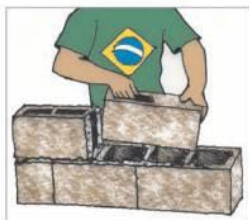
③ A argamassa é colocada nas paredes e no topo do bloco
