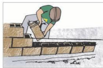
② Esticando a linha e iniciando o assentamento da fiada
